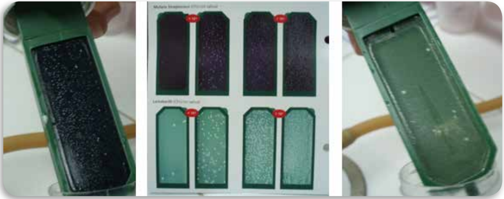
Figs .7, 8, 9 .- Resultados de la siembra, crecimiento de microorganismos, con la tabla comparativa.
